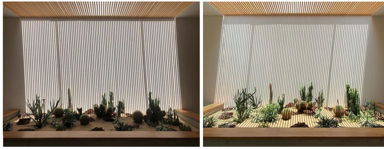
Gambar 2. Aplikasi Desain Kisi-Kisi Skylight untuk menciptakan bayangan yang berbeda sesuai dengan waktu, sebagai stimulus untuk memperkuat impresi waktu kini (Sumber: Hikari House, Pranala Associates, 2021)
